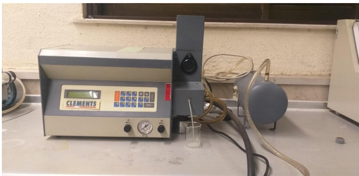
شکل ۳-۴- دستگاه نورسنج شعله‌ای مورد استفاده برای اندازه‌گیری غلظت سدیم
