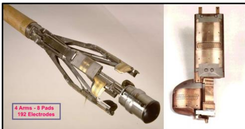
شکل ۲-۱۰: نمایش لاگ تصویری FMI (Schlumberger, 2002)
