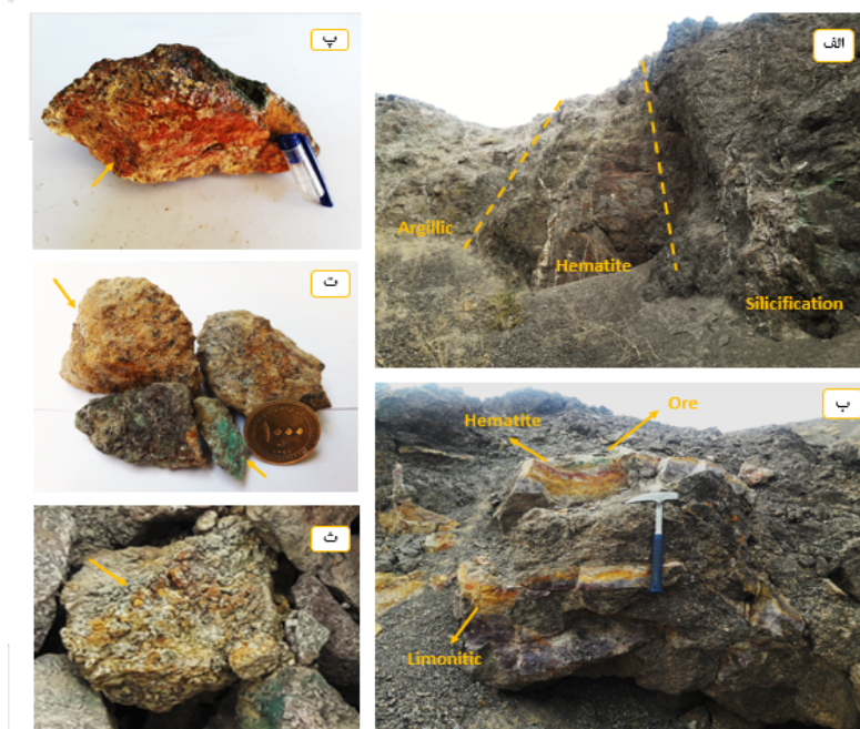
شکل ۴-۱۰: الف، ب- تصویر صحرایی از دگرسانی هماتیتی و لیمونیتی در کانسار مس چاه شیرین (دید به سمت شمال)، پ، ت، ث- تصویر نمونه دستی از دگرسانی لیمونیتی همراه با کانه‌زایی
