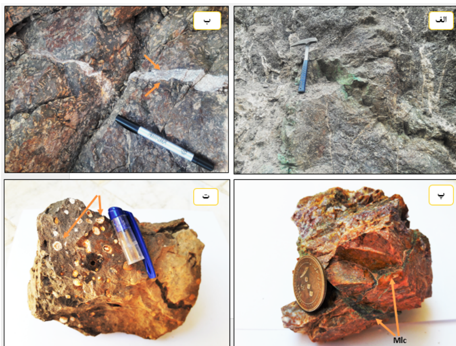
شکل ۵-۱۳: الف و ب- تصویر نمونه دستی از ساخت رگه- رگچه‌ای همراه با کانه‌زایی در نمونه آندزیتی، پ- نمونه‌ای از ساخت رگه- رگچه‌ای مالاکیت، ت- تصویر نمونه دستی از ساخت پرکننده فضای خالی و حفرات توسط سیلیس و کلسیت
