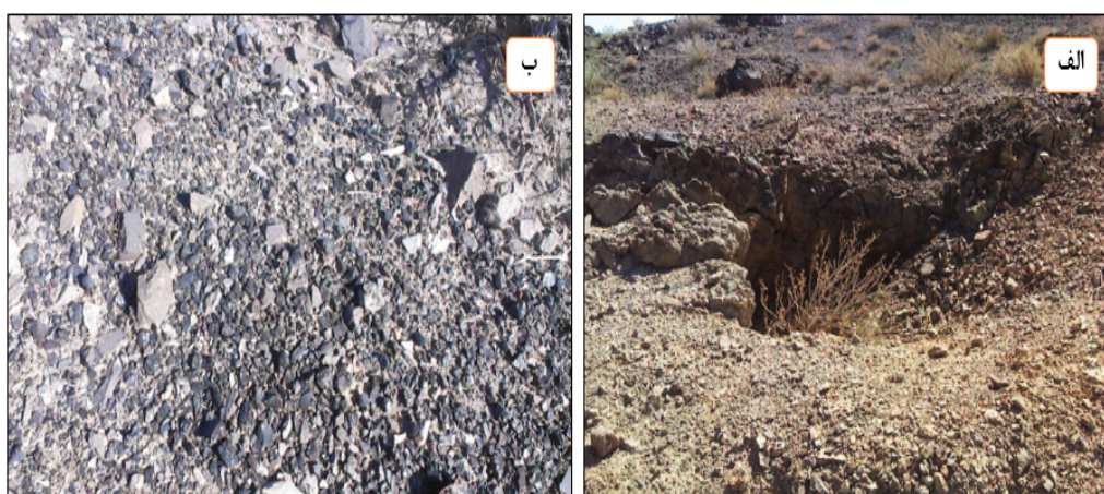
شکل ۶-۱: الف- آثار باقیمانده از یک گودال حاصل از فعالیت‌های معدنی قدیمی، ب- بقایای یک دیپوی سرباره حاصل کوره ذوب جهت استحصال ماده معدنی
