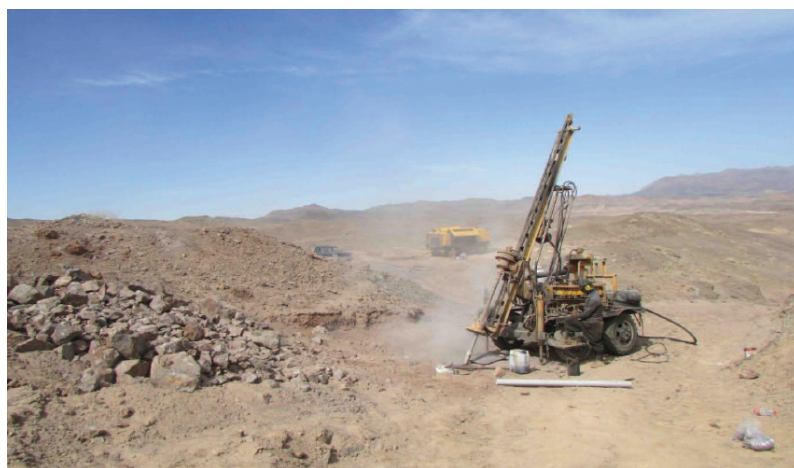
شکل ۶-۷: حفاری گمانه به روش پودری و نمونه‌برداری در کانسار چاه شیرین
