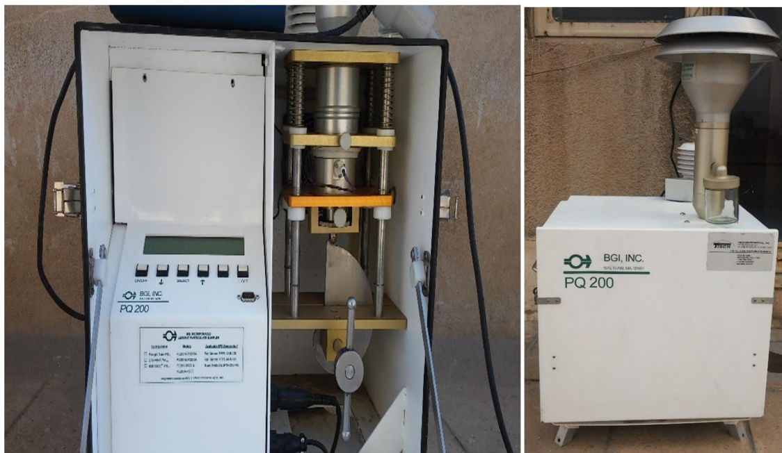
شکل (۱-۳) نصب و راه اندازی دستگاه پایین حجم مدل SAMPLERS.PQ200 WALTHMAN در پشت بام اداره محیط زیست
