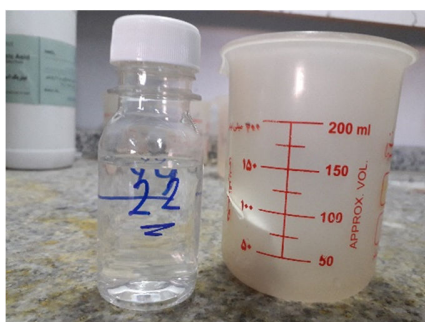
ب) رساندن به حجم 50ml توسط آب مقطر ج) انتقال محلول نهایی به ظرف
