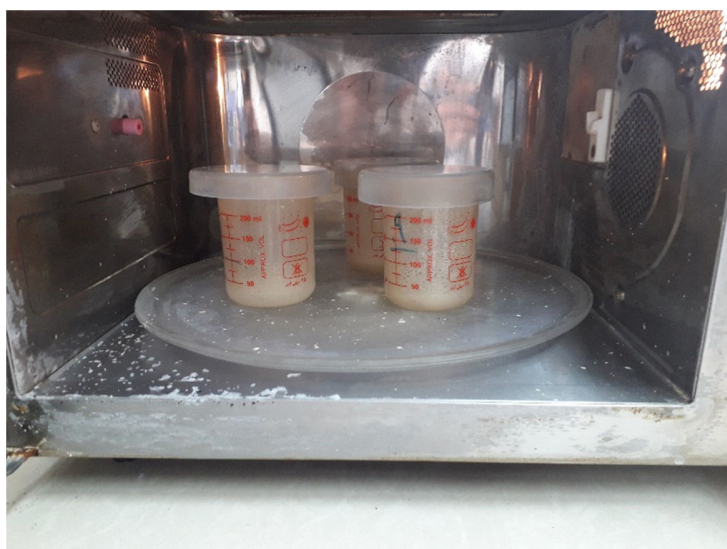
شکل (۳-۴) قرارگیری نمونه‌ها داخل دستگاه ماکروویو
