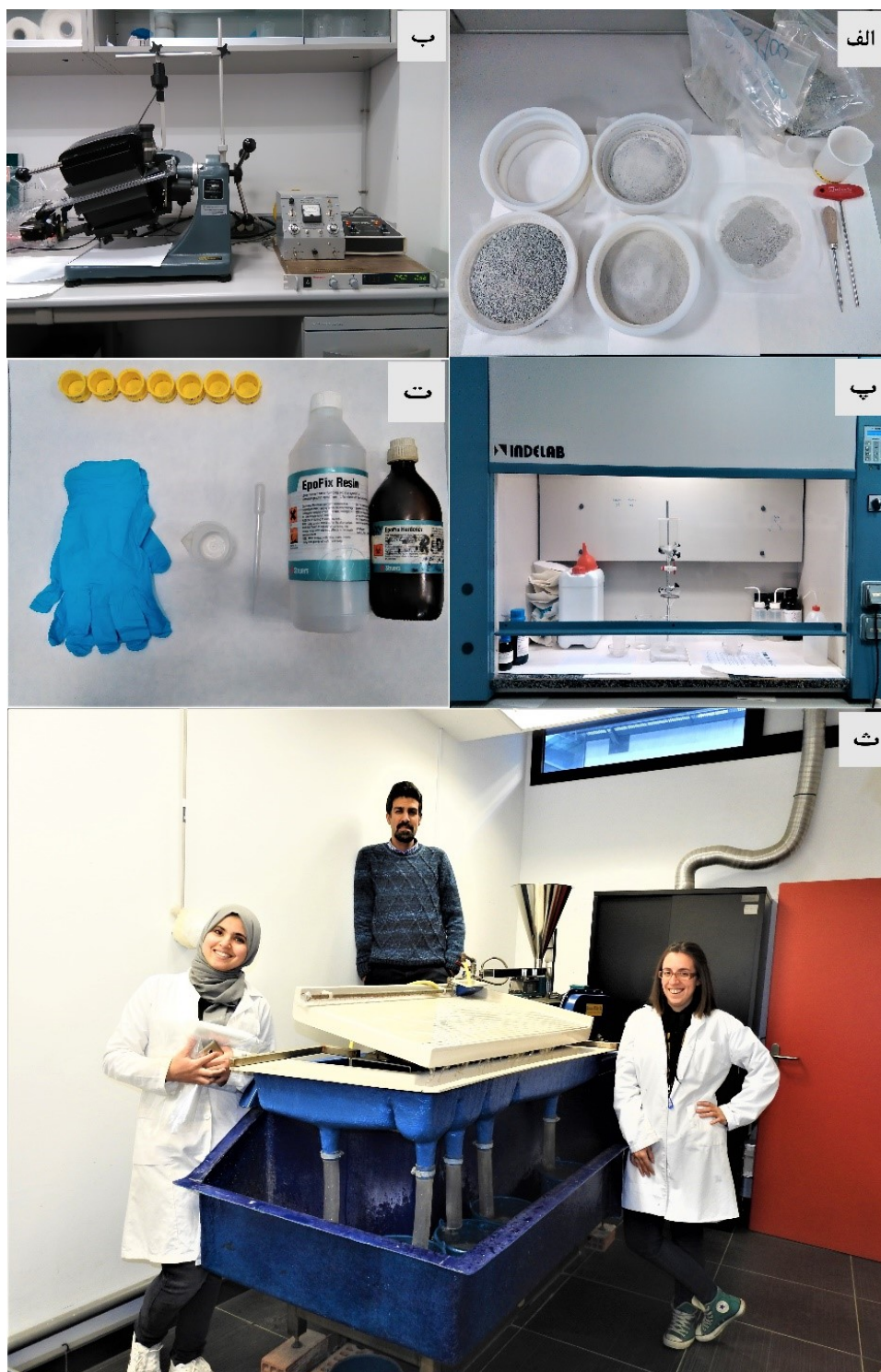
شکل ۱-۶- امکانات آزمایشگاهی مورد استفاده جهت جدایش زیرکن در موسسه IACT، الف) آلف نمونه‌ها جهت رسیدن به اندازه مش بین ۱۵۰ تا ۲۵۰ میکرون، ب) دستگاه فرانتز جهت جدایش کانی‌های با خاصیت مغناطیسی شدید، پ) جدایش کانی‌های سنگین با استفاده از دو محلول چگال، ت) تهیه مونت با استفاده از اُپفیکس رزین و اُپفیکس سفت‌کننده، ث) جدایش کانی سنگین از کانی‌های سبک با استفاده از میز لرزان.
