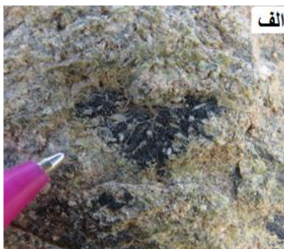
شکل ۲-۱۶- الف- تجمع موضعی تورمالین به صورت لکه‌های حاوی کوارتز تورمالین، ب- نمایی نزدیک از رگه‌های کوارتز تورمالین (پهنای کل میدان دید 10cm).
