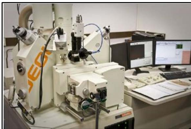
شکل ۱-۴- تصویری از دستگاه سوپر پروب نوع JEOL JSM-840A ساخت شرکت JEOL در آزمایشگاه مرکزی کانی‌شناسی و پترولوژی دانشگاه اریستوتل تسالونیسکی در کشور یونان؛ دارای ۵ طیف‌سنج با طول موج انتشاری که با شتاب دهنده‌ی ولتاژ ۲۰ کیلو ولت و جریان پرتو ۰/۴ میلی آمپر و باریکه‌ای از جریان به قطر ۵ میکرومتر انجام می‌شود (قابلیت تجزیه به صورت شبانه روزی).
