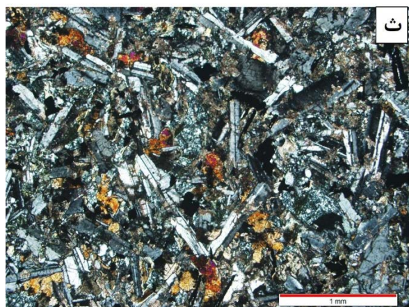
شکل ۳-۳- تصاویری از بافت‌های دیده شده در گابروها و میکروگابروها الف و ب) گابرو با بافت افیتیک و ساب افیتیک (اینترگرانولار) پ) گابرو با بافت اینترگرانولار ت) میکروگابرو با بافت اینترگرانولار ث) میکروگابرو با بافت اینترگرانولار ج) گابرو با بافت گرانولار و اسکلتی
