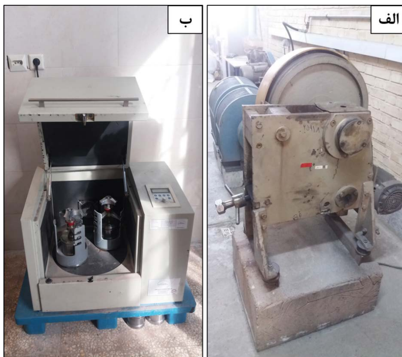
شکل ۱-۳ (الف) تصویر دستگاه سنگ شکن فکی (ب) تصویر آسیاب گلوله‌ای تنگستن کاربرد
