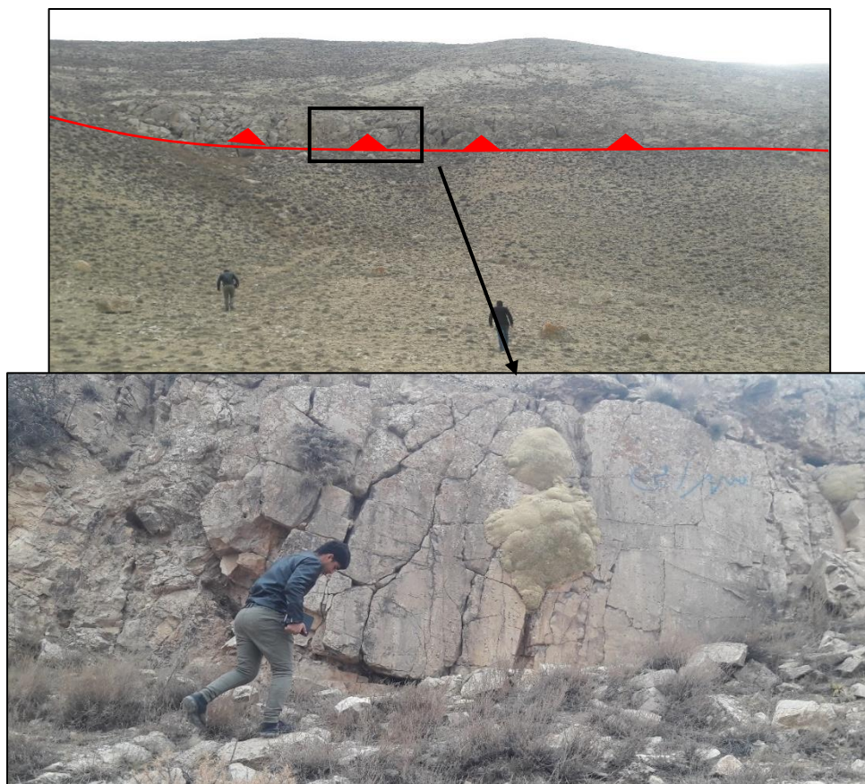
شکل ۳-۲۰ تصویر صحرایی از اثر گسل نردین. الف) رخنمون گسل با موقعیت ۸۰/۱۷۰ بر روی سازند لار در شمال روستای نردین (دید عکس به سمت شمال باختری). ب) نمای نزدیک از سطح گسل.
