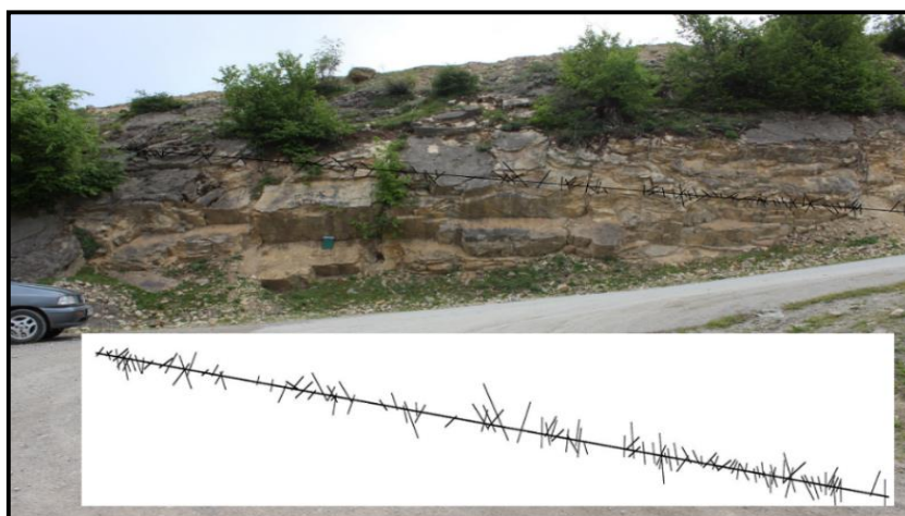
شکل ۳-۸۰- نمونه اسکن خطی در سازند الیکا (منطقه پرن)
