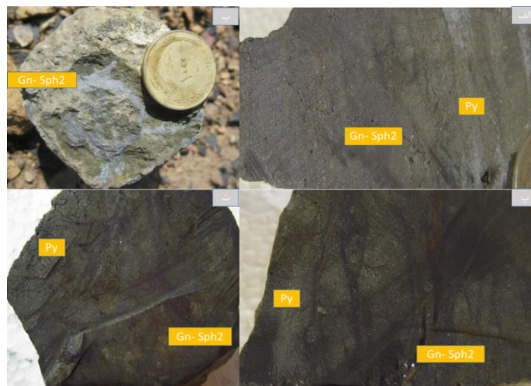
شکل ۳-۳ نمایی از رخساره توده‌ای: الف، ب، پ و ت) نمونه دستی کانسنگ توده‌ای با بافت برشی که گالن و اسفالریت (Gn-Sph2) نسل دوم جانشین پیریت نسل اول (Py) شده‌اند.
