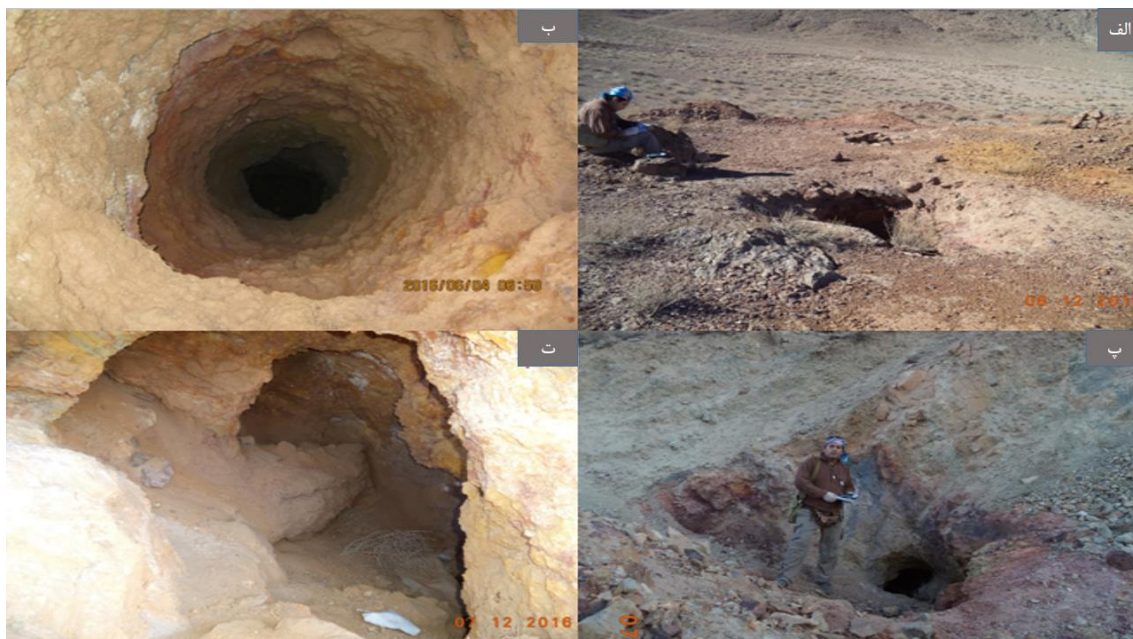
شکل ۴-۱ الف و ب) چاه‌های قدیمی حفر شده به منظور کار اکتشافی، پ و ت) تونل‌های شدادی قدیمی که به صورت دنبال رگه حفر شده‌اند.
