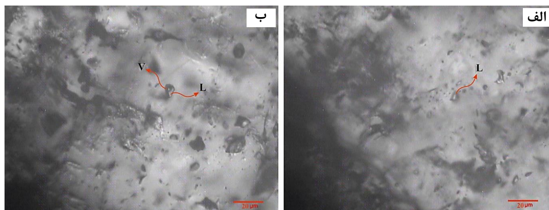
شکل ۴-۷- الف) سیالات درگیر تک‌فازی مایع (L)، ب) سیال‌های درگیر دو‌فازی مایع-گاز با محتوای فاز غالب مایع (L+V; Liquid rich).
