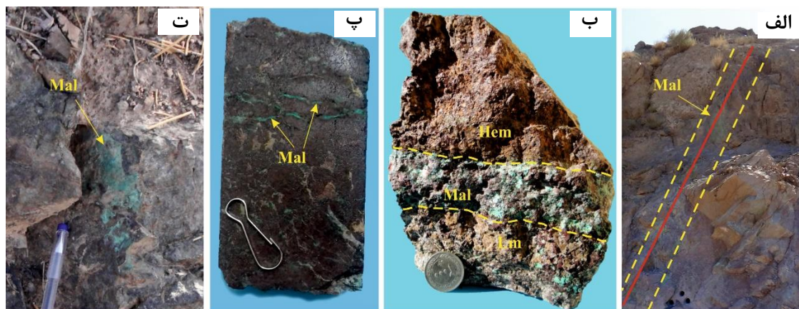
شکل ۵-۹- الف) کانی‌سازی مالاکیت در امتداد گسل (زاویه دید به سمت جنوب شرقی)، ب و پ) تصاویر نمونه‌دستی از ساخت رگه‌ای و رگه-رگچه‌ای، ت) حضور مالاکیت به صورت پرکننده فضای خالی، Mal=مالاکیت، Hem=هماتیت، Lm=لیمونیت.
