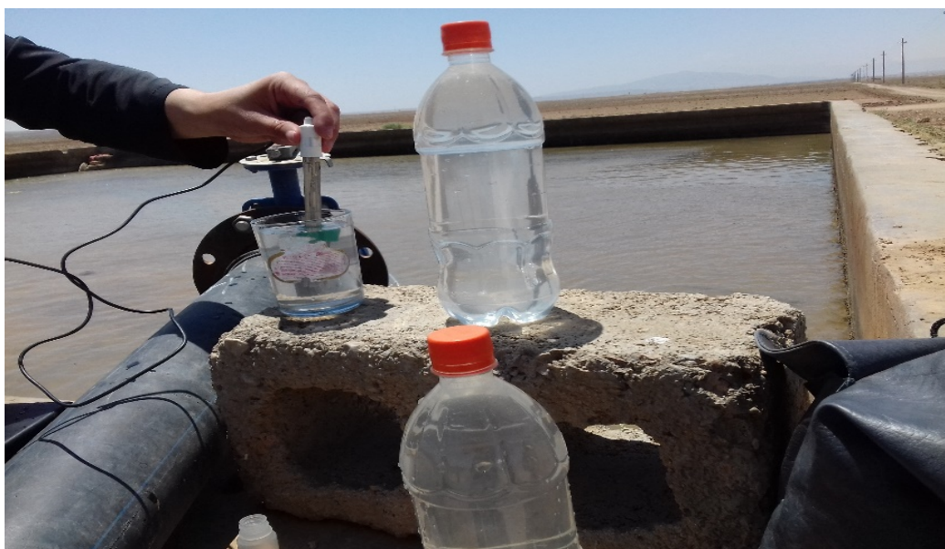
شکل ۳-۴- اندازه‌گیری EC و pH نمونه‌های آب در محل نمونه‌برداری
