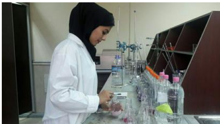
شکل ۳-۳- آنالیز شیمیایی نمونه‌های آب به روش تیتراسیون در آزمایشگاه
