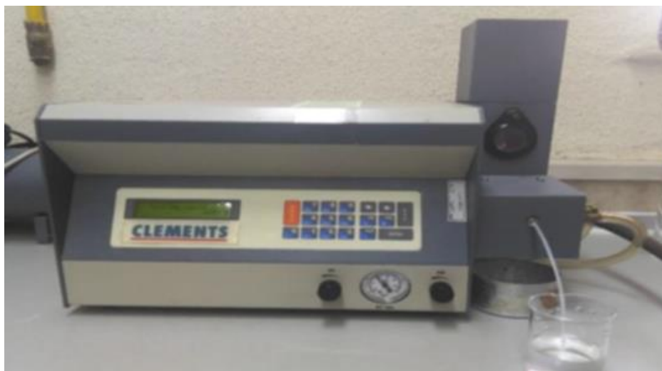
شکل ۳-۴- اندازه‌گیری سدیم و پتاسیم نمونه‌های آب با استفاده از دستگاه نورسنجی شعله‌ای
