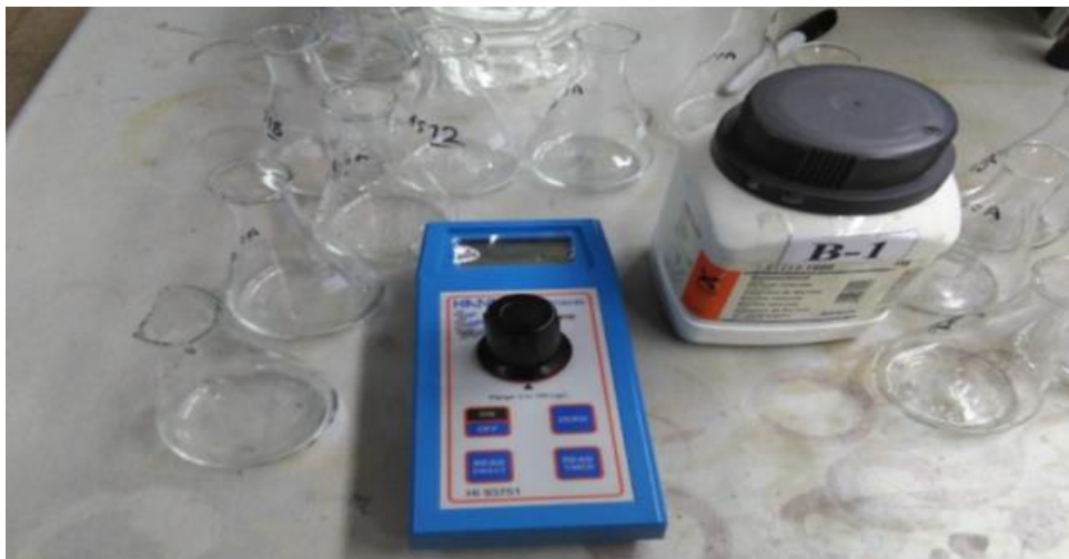
شکل ۳-۵- اندازه‌گیری مقدار سولفات نمونه‌ها با استفاده از دستگاه Hanna
