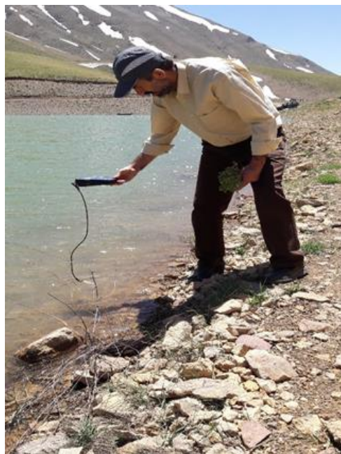
شکل ۳-۲- اندازه‌گیری هدایت الکتریکی آب ورودی به دریاچه تار
