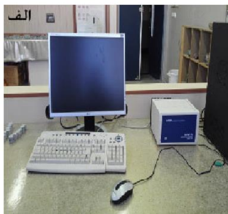
شکل ۴-۱۲- تصویری از دستگاه مغناطیس‌سنج مدل MFK1-FA ساخت شرکت (Agico) جمهوری چک موجود در آزمایشگاه ژئومغناطیس دانشگاه صنعتی شاهرود. الف) بخش ریزپردازشگر Microprocess. ب) بخش اندازه‌گیری کننده Kappabridge.
