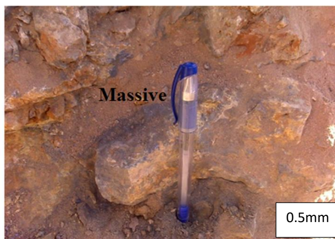
شکل ۴-۱۳: نمایی از بافت توده‌ای کانی استینیت در کانسار لخش.
