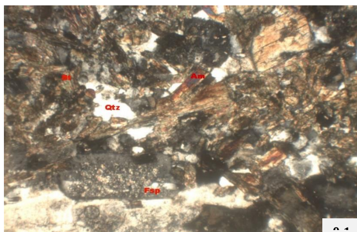
شکل ۲-۳۰: مقطع میکروسکوپی از نمونه کوارتز موزودیوریت (Am: آمفیبول، Fsp: فلدسپار، Qtz: کوارتز و Bt: بیوتیت).
