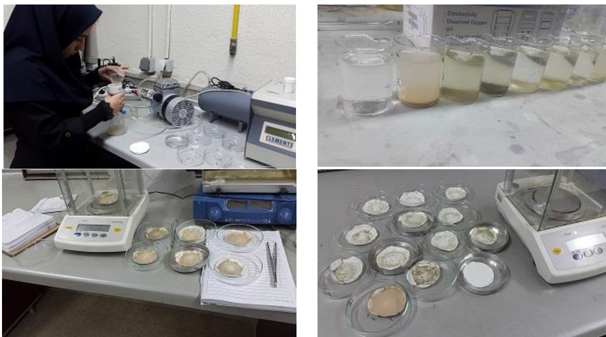
شکل ۳-۴- اندازه گیری جامدات معلق در نمونه های آب
