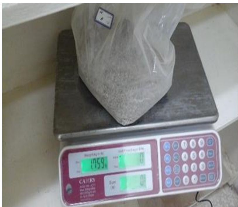
شکل ۳-۵- اندازه‌گیری وزن رسوبات باقی‌مانده روی هر الک
