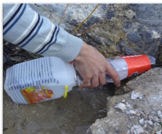
شکل ۷-۳ اندازه‌گیری دبی چشمه‌های پایین‌دست به روش حجمی
