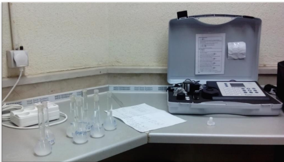
شکل ۳-۱۰ اندازه‌گیری مقدار سولفات نمونه‌ها با استفاده از دستگاه کدرسنجی
