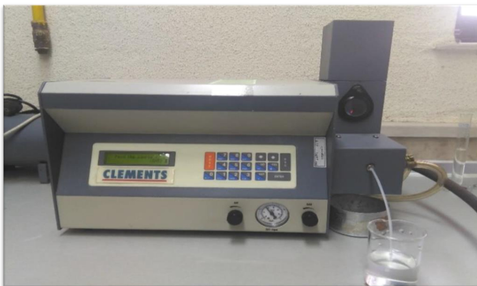
شکل ۳-۱۱ اندازه‌گیری سدیم و پتاسیم نمونه‌های آب با استفاده از دستگاه نورسنجی شعله‌ای
