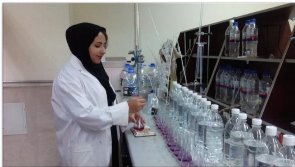
شکل ۳-۹ آنالیز شیمیایی نمونه های آب به روش تیتراسیون در آزمایشگاه
