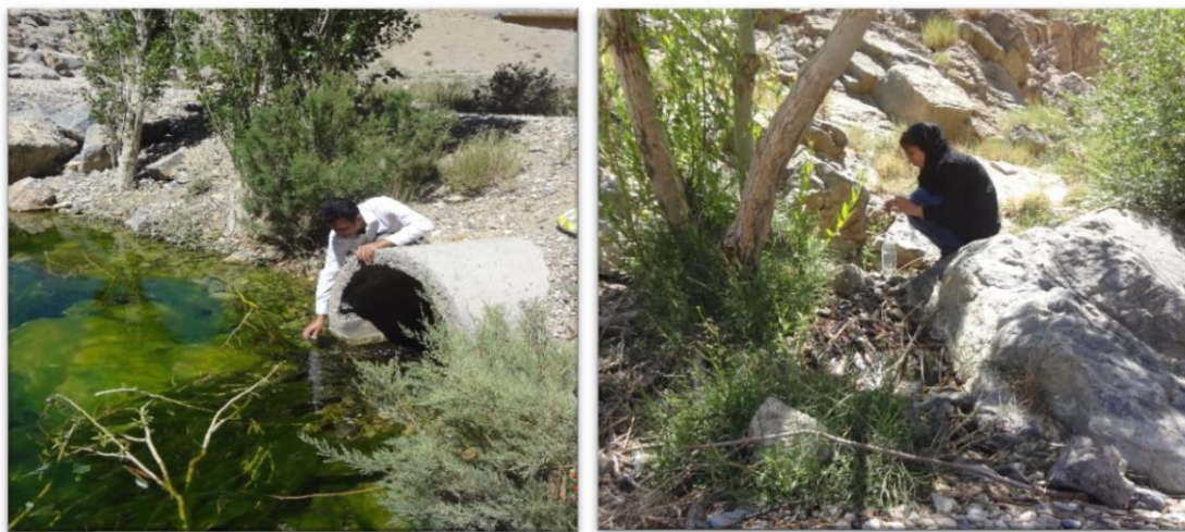
شکل ۳-۵ نمونه برداری از چشمه های پایین دست در تکیه گاه راست ساختگاه سد دامغان
