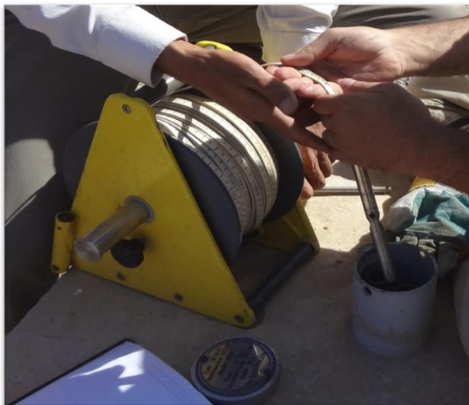
شکل ۳-۸ تعیین عمق برخورد به آب در چاه‌های مشاهده‌ای
