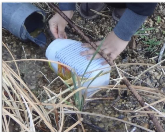
شکل ۷-۳ اندازه‌گیری دبی چشمه‌های پایین‌دست به روش حجمی
