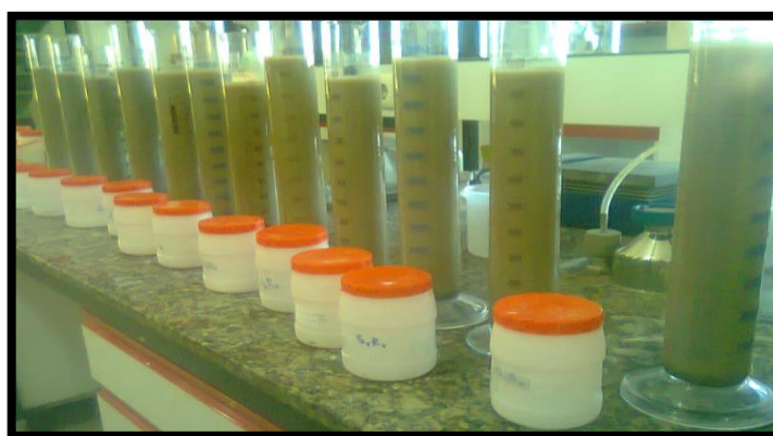
شکل (۳-۴): نمایی از روش هیدرومتری انجام شده بر روی نمونه‌های رسوب در آزمایشگاه
