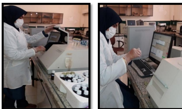
شکل (۳-۱۱): نمایی از مرحله اندازه‌گیری غلظت هیدروکربن‌های نفتی توسط دستگاه اسپکتروفتومتر
