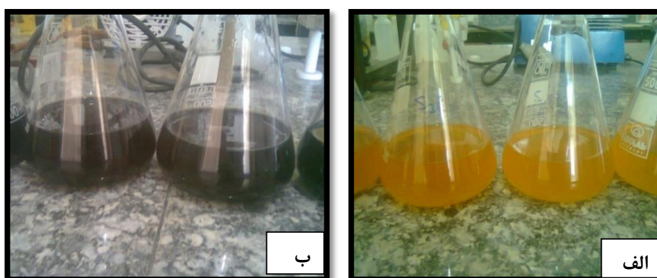
شکل (۳-۶): الف و ب: اندازه‌گیری کربن آلی به روش اکسایش شیمیایی
