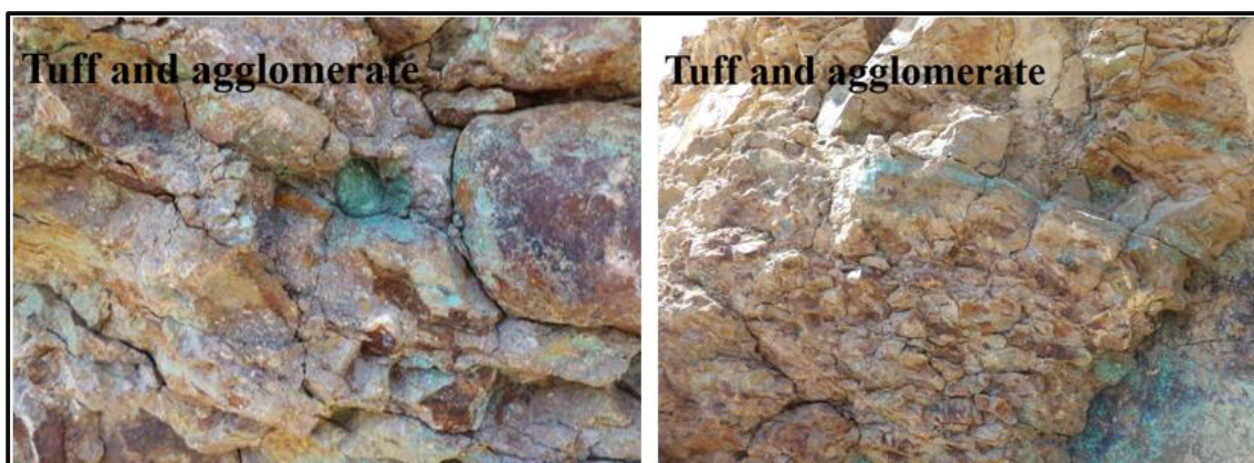
شکل ۳-۷- کانه‌زایی به صورت پرکننده فضاهای خالی و پرکننده شکستگی‌ها در واحد آذرآواری (ابری).
