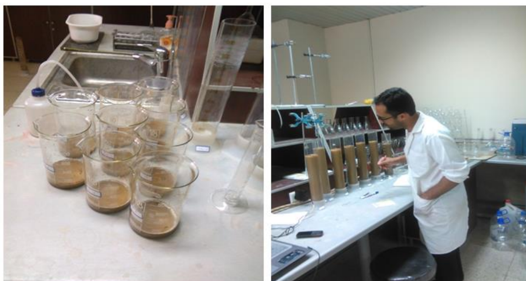
شکل ۳-۱۱- مراحل انجام آزمایش هیدرومتری
