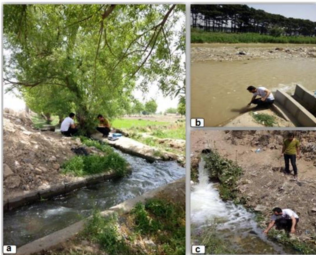
شکل ۱-۳- نمونه‌برداری از آب‌های مورد استفاده در آبیاری (a). آب زیرزمینی (b). فاضلاب خام (c). پساب (فاضلاب تصفیه شده)
