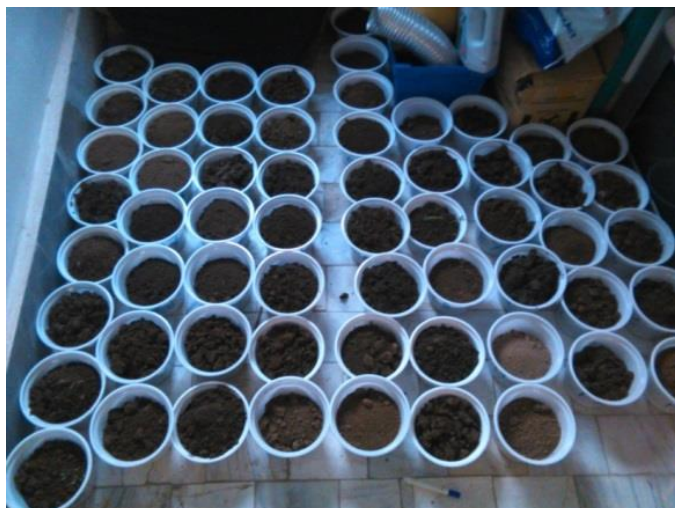
شکل ۳-۹- خشک کردن نمونه‌های خاک
