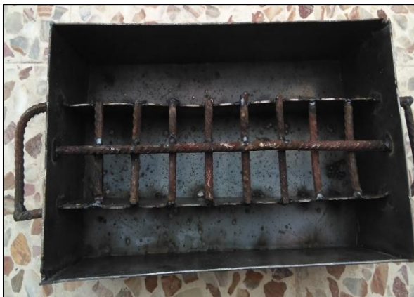
شکل ۳-۵- شبکه بندی داخلی دستگاه نمونه برداری عمقی
