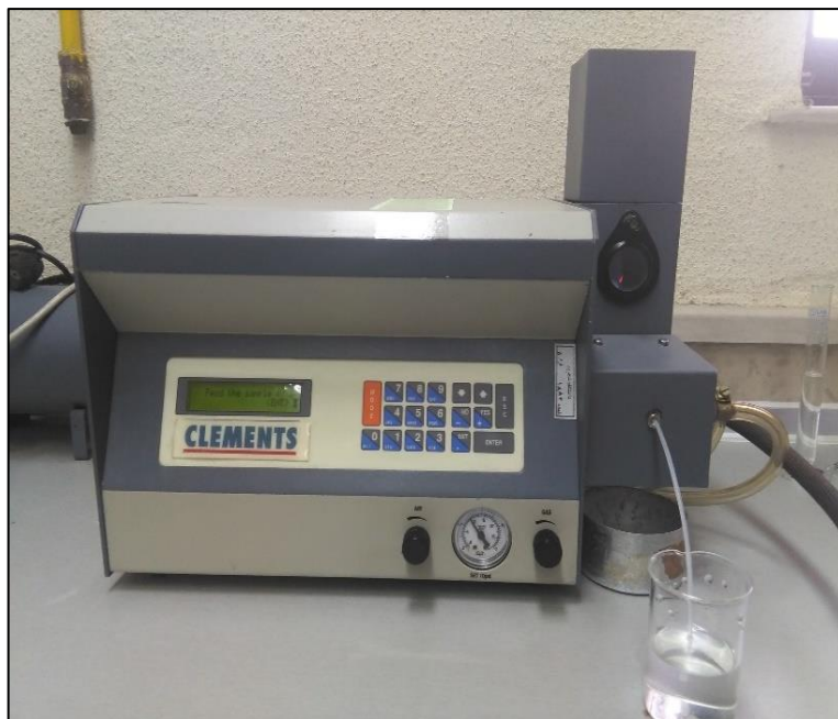
شکل ۳-۹- اندازه‌گیری سدیم و پتاسیم نمونه‌ها با استفاده از دستگاه فلیم‌فتمتری
