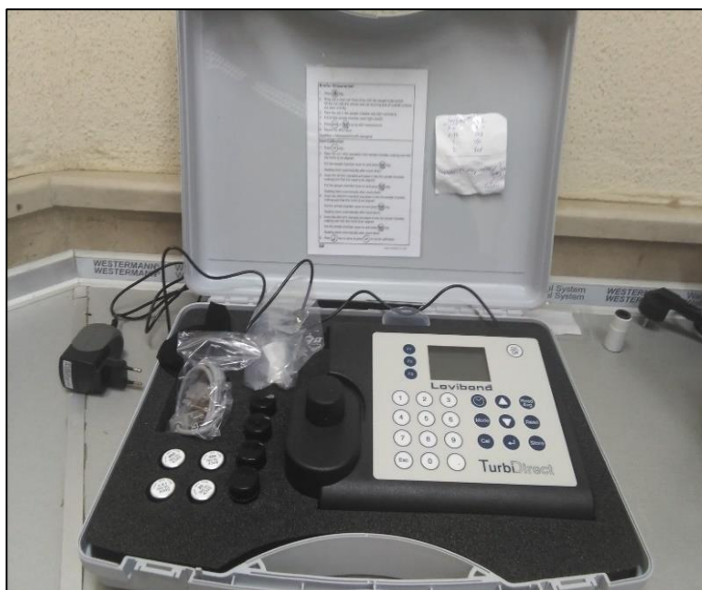
شکل ۳-۱۰- اندازه‌گیری سولفات نمونه‌ها با استفاده از دستگاه توربیدی‌متر
