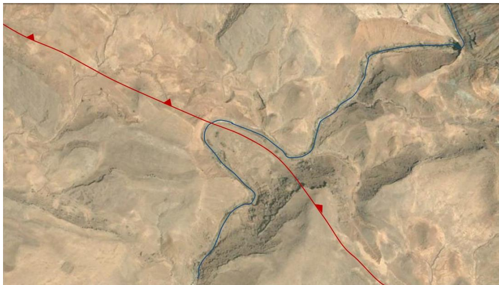
شکل ۳-۱۹: تصویر تغییر شکل آبراهه‌ها در راستای گسل منطقه (تصاویر ماهواره‌ای برگرفته از Google Earth). آبراهه در موقعیت جغرافیایی 32^{\circ}38'N و 47^{\circ}35'E قرار دارد.
