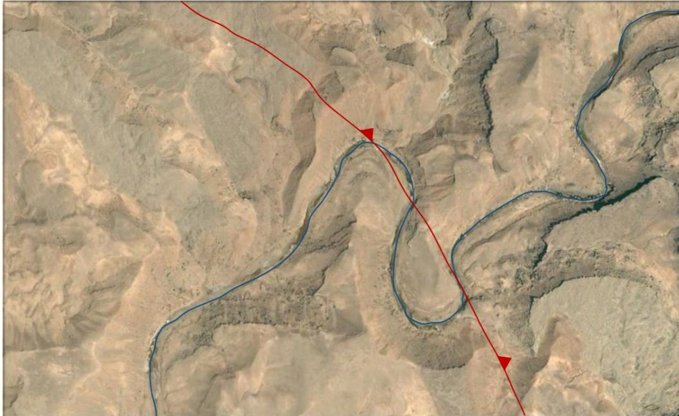
شکل ۳-۱۸: تصویر تغییر شکل آبراهه‌ها در راستای گسل منطقه (تصاویر ماهواره‌ای برگرفته از Google Earth). آبراهه در موقعیت جغرافیایی 32^{\circ}37'N و 47^{\circ}37'E قرار دارد.
