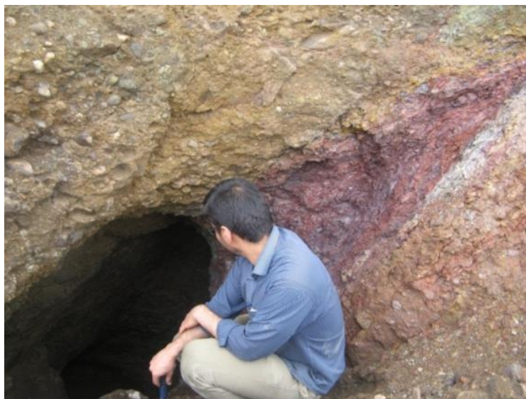
شکل ۶-۲۷: نمایی از چاهک حفاری (DH3) که کانه زایی به صورت نامتقارن در کمرباین گسل تشکیل شده است.
