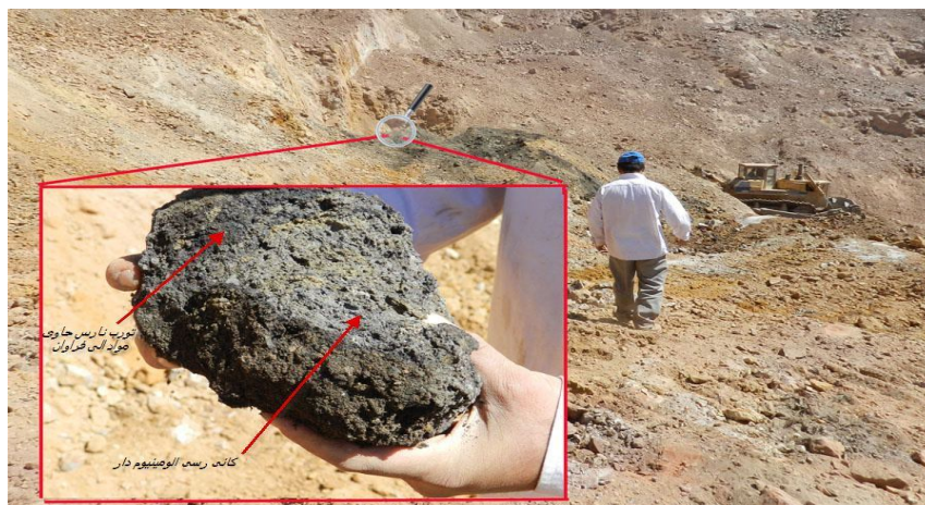
شکل ۳-۱۴- تصویر نمونه دستی یک تورب نارس که کانی‌های رسی را در بر گرفته است، لایه‌های متحد المركز نشان از تشکیل در یک محیط درجا دارد تا جایی که نمونه حالت کنکرسیون به خود گرفته است.
