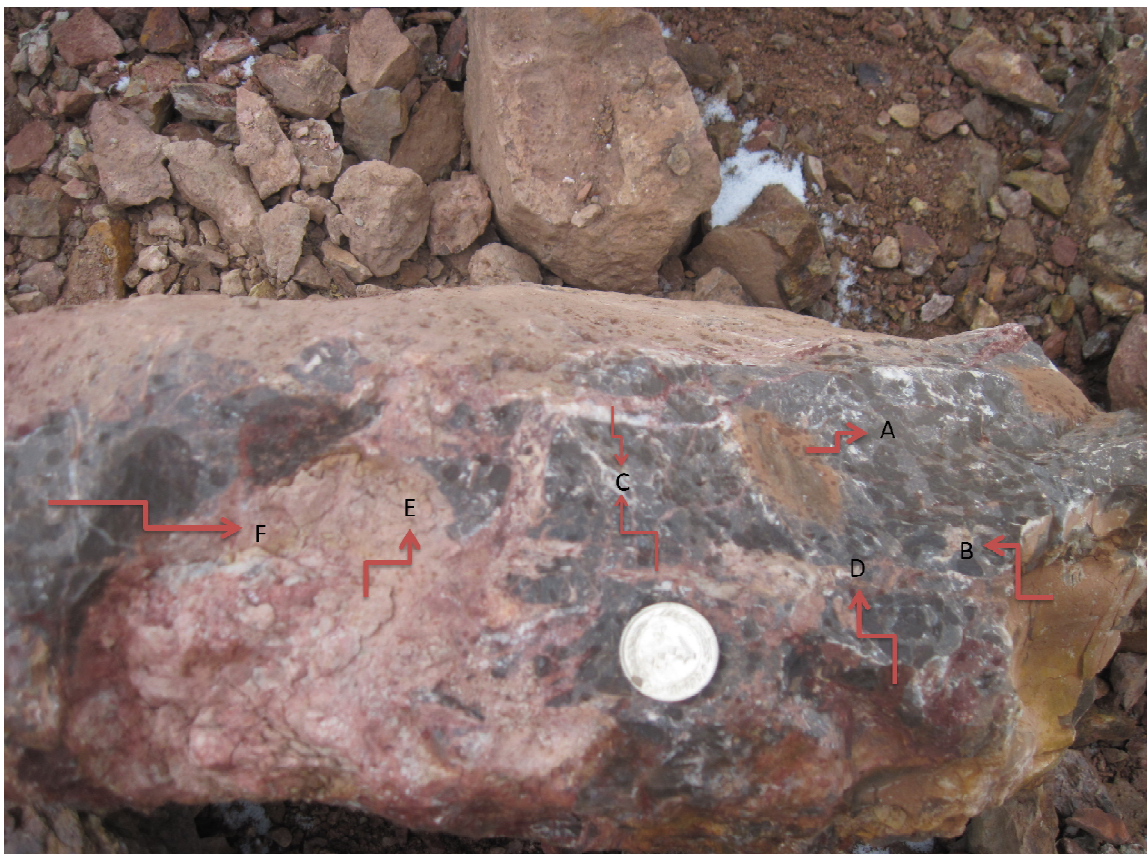
شکل ۳-۱۶ - نمایی از ورود محلول‌های حاوی بوکسیت و هماتیت در داخل بستر کربناته سازند الیکا علائم اختصاری شامل (A- ندول‌های هماتیت در زمینه بوکسیت رسی، B- بافت پلئیتومرفیک در بوکسیت رسی، C- رگچه‌های حاوی بوکسیت، D- هماتیت، E- بوکسیت کائولینیتی شده، F- دولومیت الیکا)
