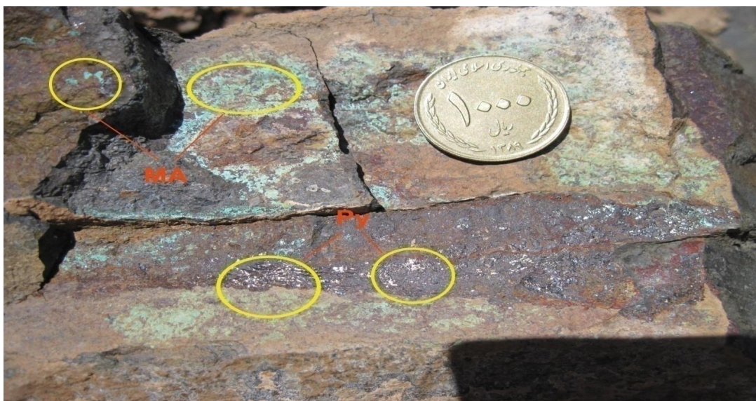
شکل ۳-۸-۳، نمایی از بوکسیت سخت رخساره احیایی در کانسار بوکسیت تاش، PY معرف پیریت و MA معرف مارکاسیت می باشد.
