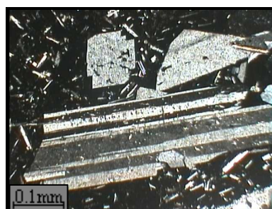
شکل ۳-۱۲-ج- تصویر میکروسکوپی فنوکریست‌های پلاژیوکلاز در سنگ‌های بازالتی (بافت پورفیری). (XPL، بزرگنمایی ۱۰۰ برابر).
