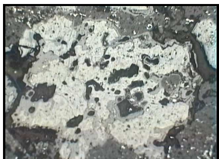
شکل ۴-۶-و- تصویر میکروسکوپی پیرولولزیت که به صورت دواير متحالمركز فضای بین سایر کانیه‌ها را پر کرده است (نور انعکاسی، بزرگنمایی ۱۰۰ برابر).
