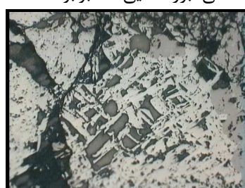
شکل ۲-۶-ط- تصویر میکروسکوپی مگنتیت که به هماتیت تبدیل شده و بافت جعبه‌ای ایجاد کرده است (بخشهای سفید رنگ، هماتیت) (نور انعکاسی، بزرگنمایی ۴۰ برابر).
