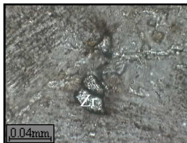
شکل ۳-۸-ج- تصویر میکروسکوپی معرف حضور زیرکن در سنگ‌های سیینیتی (PPL، بزرگنمایی ۴۰۰ برابر).
