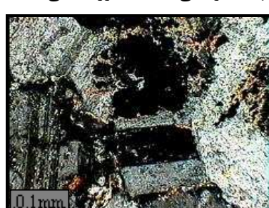
شکل ۳-۱۰-ز- تصویر بلورهای پلاژیوکلاز و مگنتیت (مگنتیت به صورت خمیره بین بلورهای پلاژیوکلاز را پر کرده است) (XPL، بزرگنمایی ۱۰۰ برابر).
