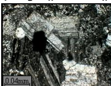
شکل ۳-۱۰-ه- تصویر میکروسکوپی نشان‌دهنده ادخالهای مگنتیت در پورفیروئیدهای پلاژیوکلاز موجود در سنگ‌های گرانیتی (XPL، بزرگنمایی ۴۰۰ برابر).
