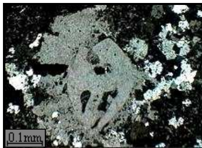
شکل ۳-۱۴- ج- تصویر میکروسکوپی نشان‌دهنده بلورهای نوظهور کوارتز بر روی بلور کوارتز قبلی که در اثر دگرگونی مجاورتی رشد کرده‌اند (آثار خلیج‌خوردگی در حاشیه بلور کوارتز قبلی هنوز قابل مشاهده است) (نور XPL، بزرگنمایی ۱۰۰ برابر).
