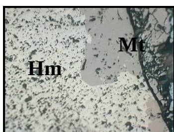
شکل ۲-۶-ح- تصویر میکروسکوپی مگنتیت به رنگ خاکستری و هماتیت به رنگ سفید روشن (نور انعکاسی، بزرگنمایی ۴۰ برابر).
