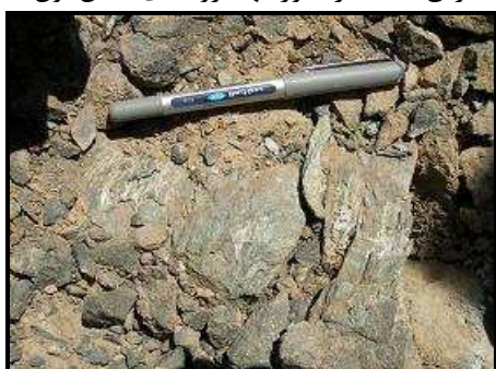
شکل ۲-۳۲- تصویری از بلورهای آکتینولیت رشد کرده بر سطح درز و شکاف های دیوریتها (دره پوستیون).
