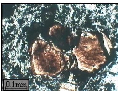
شکل ۳-۱۲-ز- تصویری از الیوین‌های ایدنگسیتی شده در بازالت‌ها (XPL، بزرگنمایی ۱۰۰ برابر).
