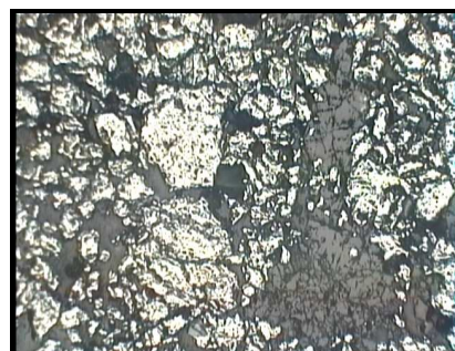
شکل ۴-۶-ه- تصویر میکروسکوپی منگنز (پیرولولزیت) که به رنگ سفید به صورت نوارهای متحالمركز فضای بین سایر کانیه‌ها را پر کرده است (نور انعکاسی، بزرگنمایی ۴۰ برابر).
