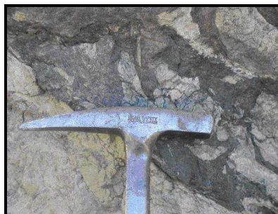
شکل ۳-۶-الف- تصویری از کانه‌زایی مگنتیت به صورت رگه و رگچه‌ای در شمال روستای علی آباد.
