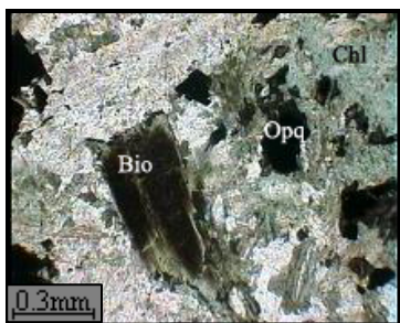
شکل ۳-۷-ب- تصویر میکروسکوپی نشاندهنده دگرسانی بیوتیت و سایر کانیهای مافیک به کلریت (PPL، بزرگنمایی ۴۰ برابر).
