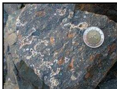
شکل ۳-۱۲-الف- تصویری از ساخت بادامکی در نمونه دستی سنگ‌های بازالتی (شرق روستای بهدان).
