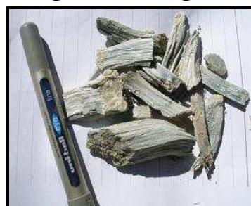
شکل ۳-۷-ج- تصویری از بلورهای چند سانتیمتری آکتینولیت‌های الیافی شکل و آبی رنگ ( محل نمونه برداری شمال روستای علی آباد).
