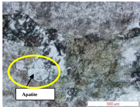
شکل ۳-۱۲) تصویر میکروسکوپی از مقاطع نازک تهیه شده مربوط به توده نفوذی. بلور هگزائگونال آپاتیت به همراه هورنبلند با رخ لوزی شکل، حالت. PPL
