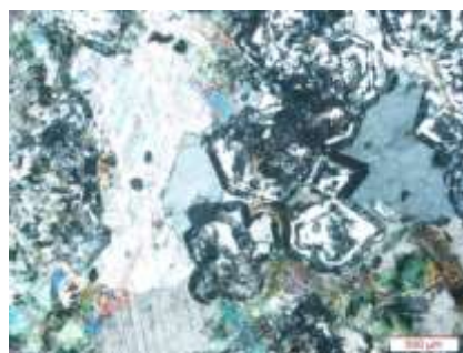
شکل ۴-۴) تصویر میکروسکوپی از مقاطع نازک تهیه شده مربوط به توده اسکارنی. الف: گارنت زون‌بندی شده که در داخل و یا در راستای زون‌ها بوسیله کلسیت، کوارتز و مقدار کمی اپیدوت پر شده است. حالت XPL
