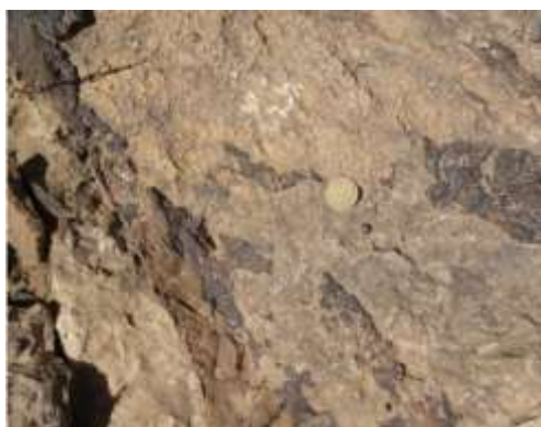
شکل ۴-۱۰ پراکندگی آهن در آهک بصورت رگه و لنزهای کوچک
