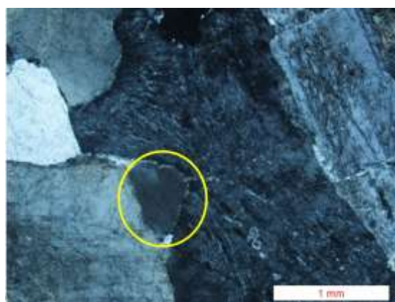
شکل ۳-۵ ادخال کوارتز درون آلکالی فلدسپات، حالت XPL
