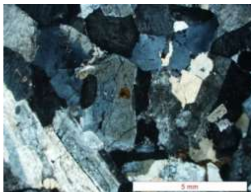
شکل ۳-۱۷) تصویر میکروسکوپی از مقاطع نازک تهیه شده مربوط به توده نفوذی. بافت گرانولار در نمونه‌های مورد مطالعه، حالت XPL
