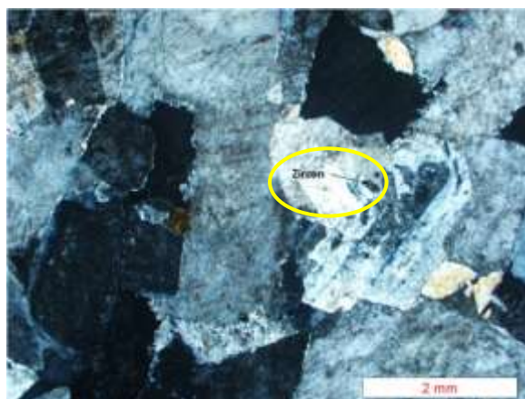
شکل ۳-۱۳) تصویر میکروسکوپی از مقاطع نازک تهیه شده مربوط به توده نفوذی. بلور زیرکان به همراه پلاژیوکلاز، کوآرتز، بیوتیت و آلکالی فلدسپات، حالت XPL
