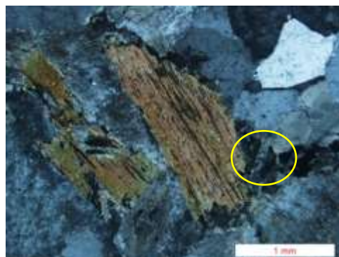
شکل ۳-۱۱ تصویر میکروسکوپی از مقاطع نازک تهیه شده مربوط به توده نفوذی. تشکیل اسفن از کانی‌های مافیک مانند بیوتیت، حالت XPL
