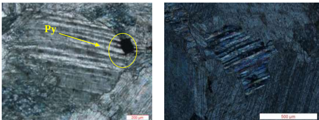
شکل ۳-۲۳) تصویر میکروسکوپی از مقاطع نازک تهیه شده مربوط به توده نفوذی. الف: ماکل پلی سنتتیک کلسیت، حالت XPL، ب: تشکیل پیریت درون کلسیت، حالت XPL
