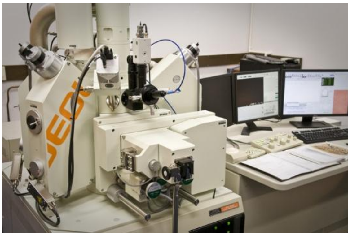
شکل ۱-۴- تصویری از دستگاه سوپرپروب نوع JEOL JXA-8230 ساخت شرکت JEOL در آزمایشگاه مرکزی دانشگاه فنی خاورمیانه در کشور ترکیه.
