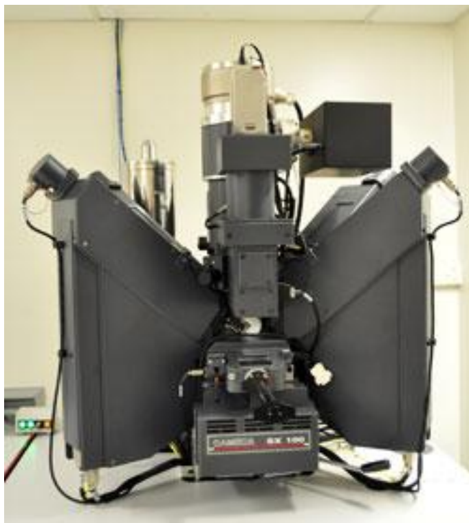
شکل ۱-۳- تصویری از دستگاه سوپرپروب نوع SX100 ساخت شرکت Cameca فرانسه در مرکز تحقیقات فراوری مواد معدنی ایران.
