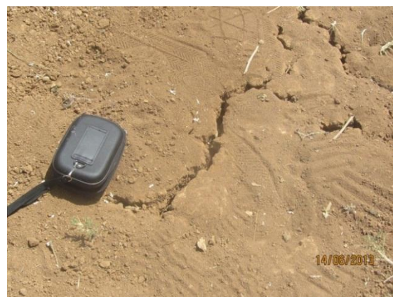
شکل ۴-۲۲- ترک در خاک‌های کارستی منطقه بر اثر زهکشی زیرسطحی قابل توجه منطقه
