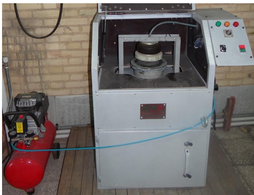
شکل ۱-۱۳: تصویر دستگاه پودرکن (هاون) مورد استفاده برای پودر کردن نمونه‌ها جهت آنالیز شیمیایی، (آزمایشگاه کانه آرای و فلوتاسیون دانشکده معدن دانشگاه شاهرود).
