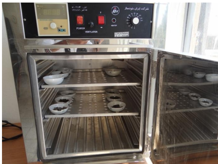
شکل ۱-۱۲: تصویر دستگاه گرمکن مورد استفاده برای خشک کردن آب اضافه شده بین دانه‌ای، (آزمایشگاه رسوب‌شناسی دانشکده علوم زمین دانشگاه شاهرود).
