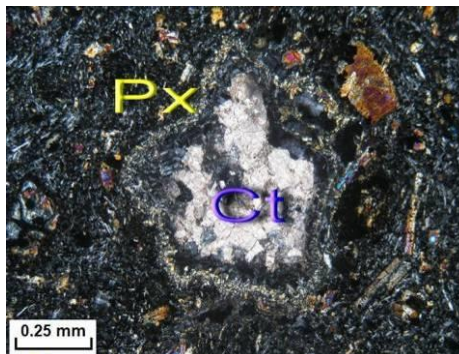
شکل ۳-۳۴- رشد بلورهای اوژیت در اطراف حباب گاز (XPL).
