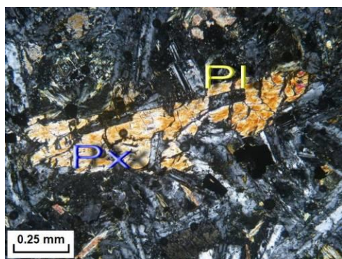
شکل ۳-۱۳- بافت ساب افیتیک، در اثر قرارگیری بلورهای پلاژیوکلاز در متن بلور اوژیت (XPL).
