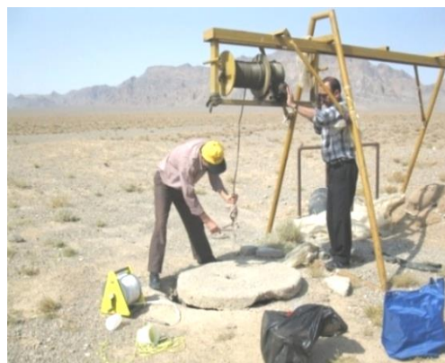
شکل ۴-۹- اندازه‌گیری هدایت الکتریکی در بالادست قنات
