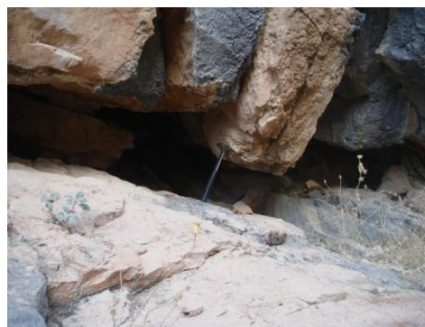
شکل ۴-۱۷- دو نمونه از درزه‌های در امتداد لایه‌بندی (دسته ۳). به ابعاد و بازشدگی این دسته از درزه‌ها دقت شود.
