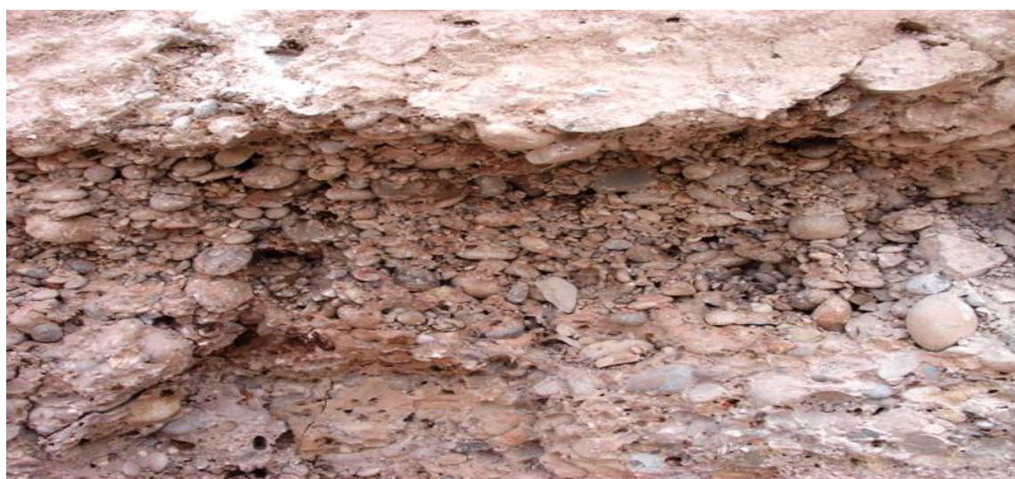
شکل ۵-۱: عدسی های گراول بدون سیمان (Open gravel) در بین لایه های کنگلومرا
