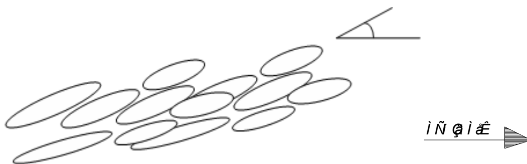
شکل ۳-۳ طرز قرار گیری قلوه سنگها در جهت جریان
