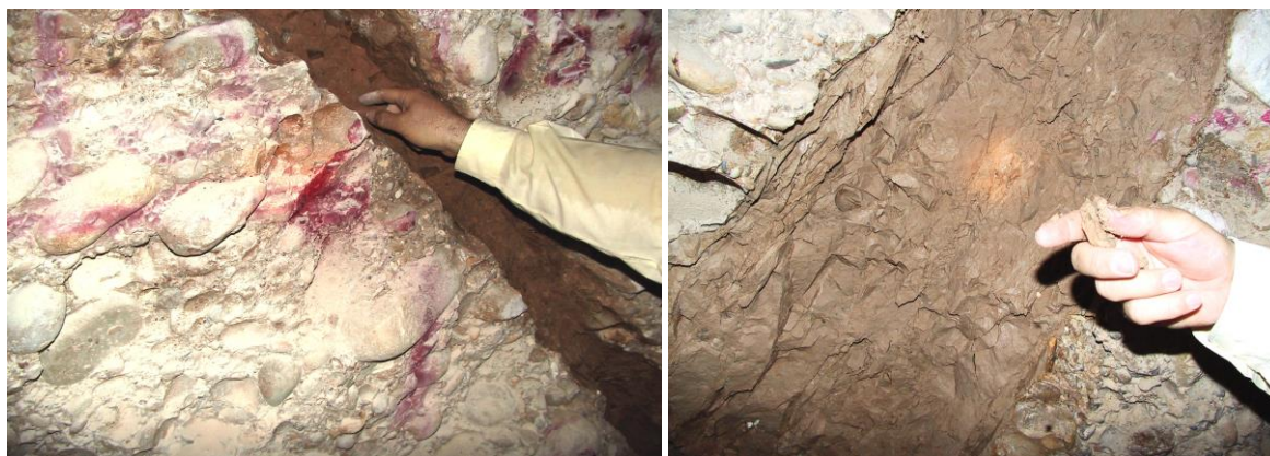
شکل ۵-۲: رس بین لایه ای موجود در بین لایه های کنگلومرا
