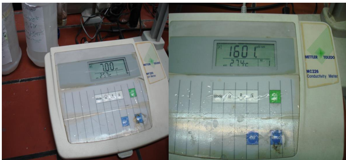
شکل ۵-۳- اندازه گیری pH و EC با دستگاه مدل ۲۲۰ متر - اهم و دستگاه هدایت سنج مدل ۲۲۶ متر - اهم
