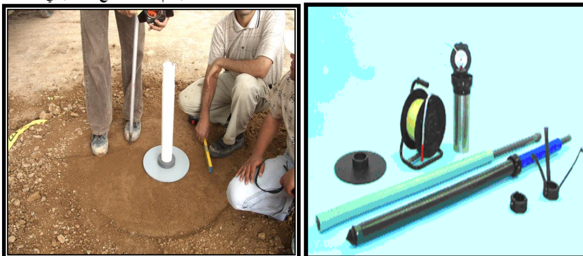
شکل 3-15- نصب نشست سنج داخل خاکریز
