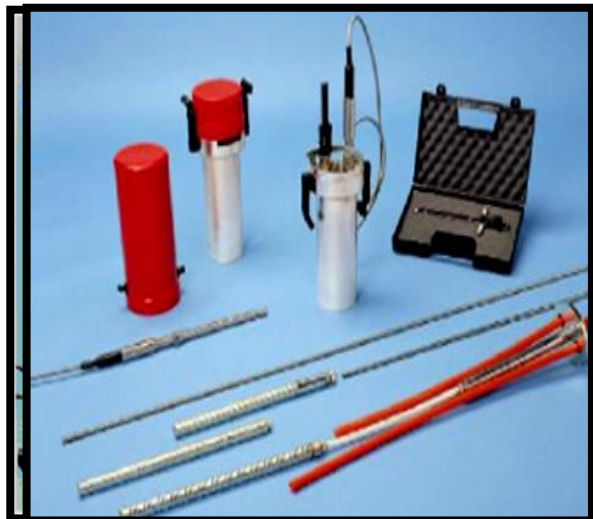
شکل 3-23- انبساط سنجهاي خاكي
