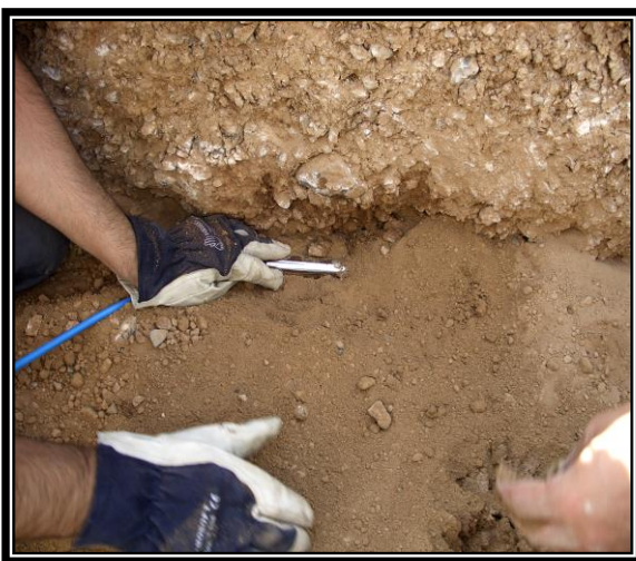
شکل 3-4- شکاف ایجاد شده برای قرار دادن سنسور
