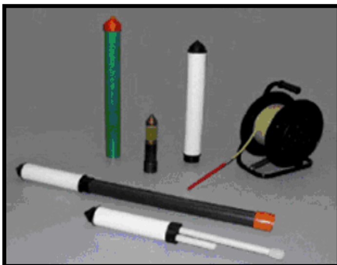
شکل 3-7- پیزومتر کاساگرانده P1010040
