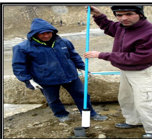
شکل 3-8- اشباع کردن فیلتر کاساگرانده
