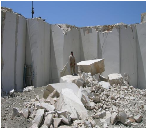
شکل ۲-۲۹- نمایی از سنگهای ریولیتی معدن دنیا مهرگان واقع در شکل ۲-۳۰- دیواره‌های حاصل از برش سنگهای ریولیتی به جنوب روستای بهانگر. روش سیم الماسه.
