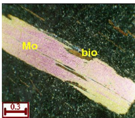
شکل ۳-۱۰- تصویر میکروسکوپی از مسکوویت درشت ثانویه که در اثر دگرسانی بیوتیت حاصل شده است و بقایای بیوتیت در آن دیده می‌شود (XPL، بزرگنمایی ۴۰ برابر).
