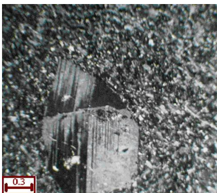
شکل ۳-۶- تصویر میکروسکوپی از فنوکریست پلاژیوکلاز نیمه شکل‌دار با ماکل پلی‌سینتتیک در ریولیت‌های معدن دنیا مهرگان (XPL، بزرگنمایی ۴۰ برابر).
