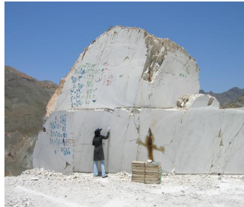
شکل ۲-۲۹- نمایی از سنگهای ریولیتی معدن دنیا مهرگان واقع در شکل ۲-۳۰- دیواره‌های حاصل از برش سنگهای ریولیتی به جنوب روستای بهانگر. روش سیم الماسه.
