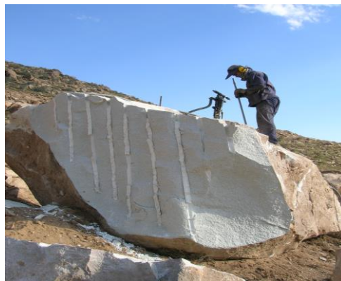
شکل ۲-۳۱- تصویری از چال‌زنی به منظور تهیه بلوک از سنگهای ریولیتی در معدن گرانتیت مهر.
