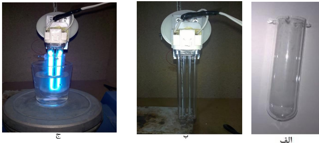
شکل (۲-۱۰) - الف) لوله کوارتزی ب) لامپ فرابنفش ج) set up آزمایش
