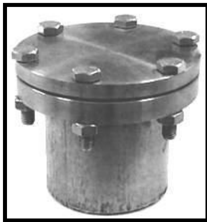
شکل ۲-۱. تصویر راکتور به کار گرفته شده برای آبکافت به شیوه‌ی هیدروترمال.
