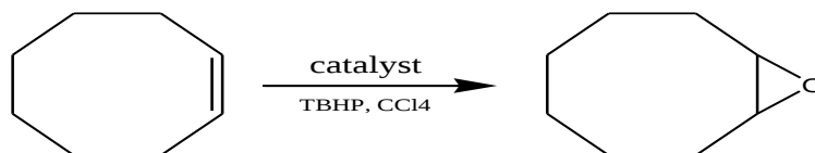
شکل ۳-۶: اپوکسایش سیکلواکتن با اکسنده ترشیوبوتیل هیدروژن پراکسید با کاتالیزگر ناهمگن Mo-AFNB
