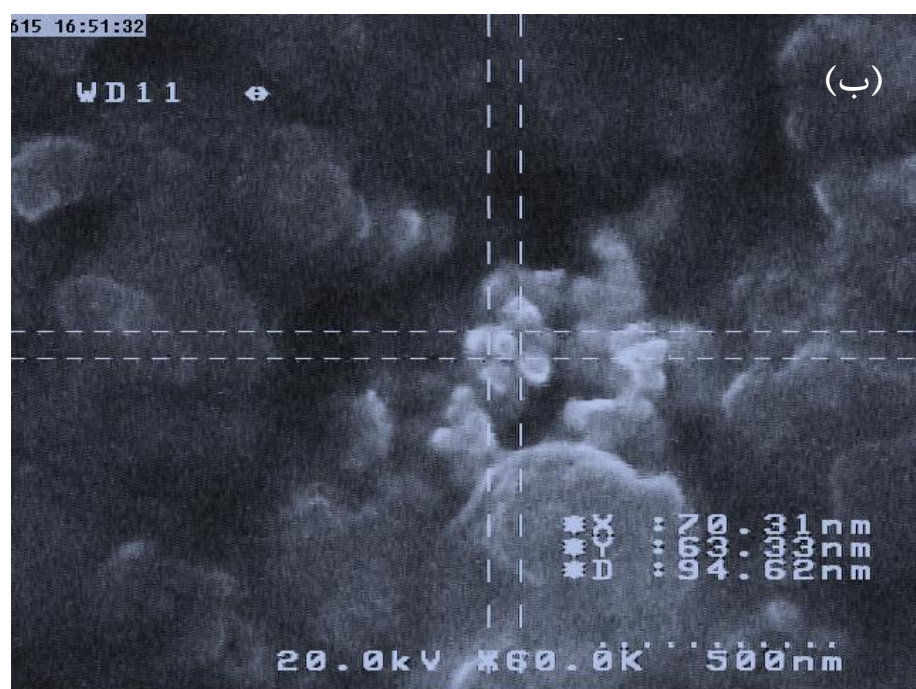
شکل (۳-۲۴): بزرگنمایی تصاویر SEM پلیمر تهیه شده به روش ولتامتری چرخه‌ای از محلول ۴/۰ mM AAQ در ۶/۰ M H 2 SO 4 (الف) فاقد SDS، (ب) حاوی SDS
