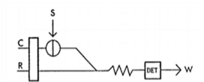
شکل (۲-۴)- طرح کلی سیستم FIA، C: حامل، R: واکنشگر، S: نمونه، DET: آشکارساز، W: پساب [۴۹].
