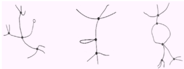
شکل (۵-۱) ناکامی‌ها در تشکیل پیوندهای عرضی [۶۴]
