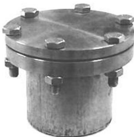
شکل (۱-۲): راکتور استیل مورد استفاده جهت آبکافت هیدروترمال آلومینیوم ۲-بوتوکسید
