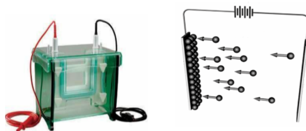
شکل (۱۸-۱) - طرح شماتیکی از سیستم لایه نشانی به روش الکتروفورز [۱۸].
