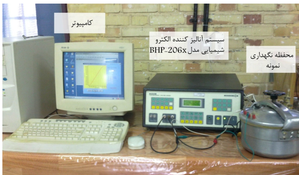
شکل ۳-۳. سامانه اندازه گیری جریان - ولتاژ مورد استفاده ما در آزمایشگاه
