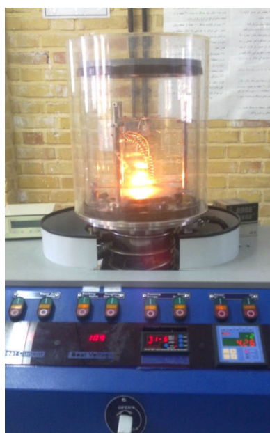
شکل ۳-۱. سمت راست تصویر شماتیک از دستگاه تبخیر حرارتی در خلا و سمت چپ دستگاه مورد استفاده در آزمایشگاه
