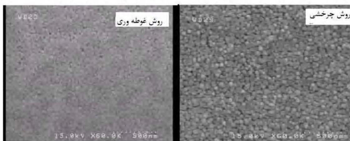
شکل (۴-۳۹) - تصاویر FESEM ثبت شده برای نمونه های سنتز شده به روش غوطه وری و چرخشی.
