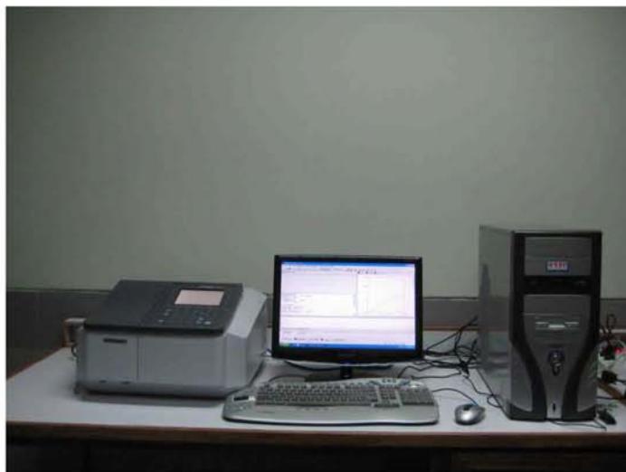
شکل (۳-۲) - دستگاه طیف سنج دوباریکه ای UV-Vis مدل UV-۱۸۰۰ شرکت Shimadzu.
