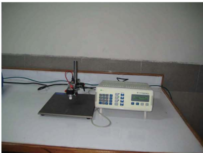
شکل (۷-۳) - دستگاه چهار پایانه ای شرکت Jundel مدل AM3-AR.
