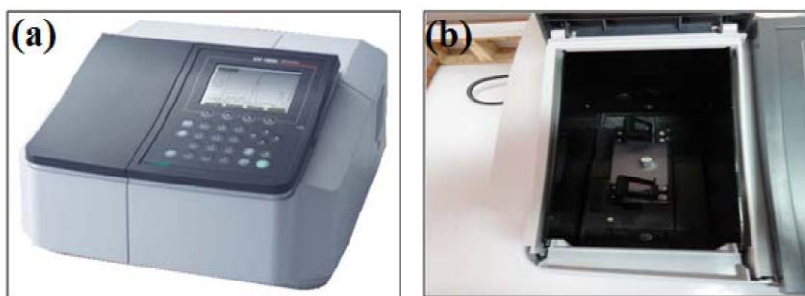
شکل ۴-۲- (a) دستگاه اسپکتروفوتومتر ( Shimadzu UV-1800 ) در دانشگاه شاهرود (b) جایگاه‌های قرار گیری نمونه‌های مرجع و شاهد.
