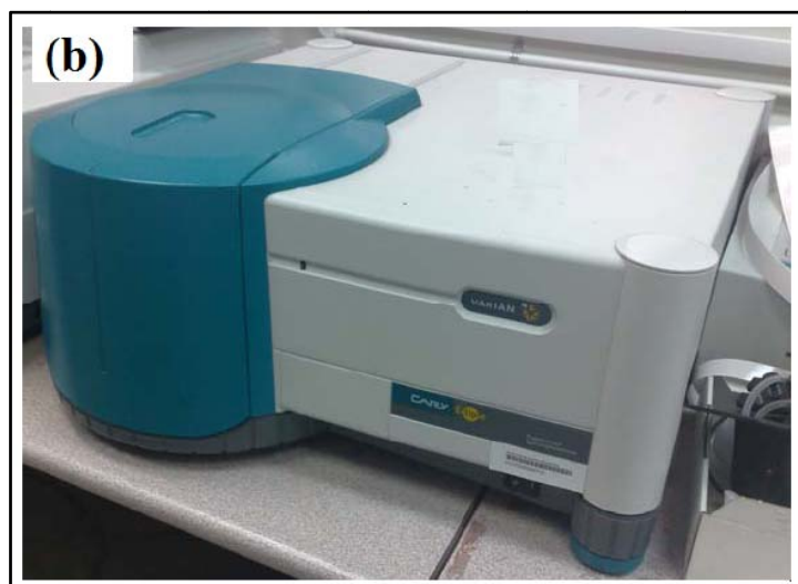
شکل ۲-۶ (a) نمودار پایه از دستگاه اسپکتروفوتومتر ، (b) دستگاه اسپکتروفوتومتر فلوئورسانس (Cary Eclipse fluorescence) در دانشگاه صنعتی شریف.
