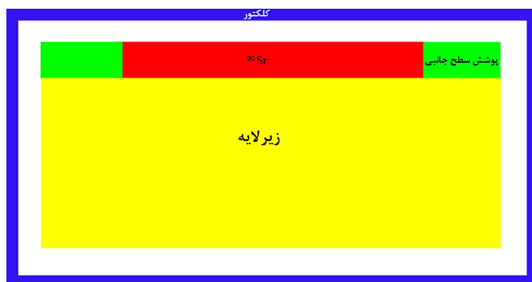
شکل ۴-۱۳. چشمه با زیرلایه و پوشش سطح جانبی داخل کلکتور استوانه‌ای
