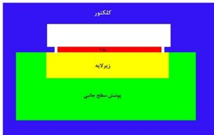
شکل ۴-۱۰. چشمه با زیرلایه و پوشش سطح جانبی داخل کلکتور استوانه‌ای
