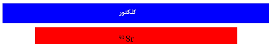
شکل ۴-۵. چشمه، بدون زیرلایه و پوشش سطح جانبی در مقابل کلکتور صفحه‌ای
