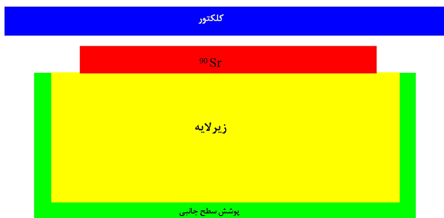
شکل ۴-۳. چشمه با زیرلایه و پوشش سطح جانبی در مقابل کلکتور صفحه‌ای
