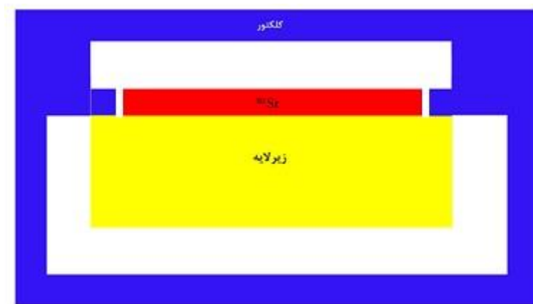
شکل ۴-۹. چشمه با زیرلایه و بدون پوشش سطح جانبی داخل کلکتور استوانه‌ای
