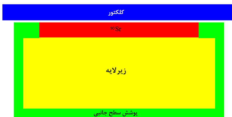
شکل ۴-۱۴. چشمه با زیرلایه و پوشش سطح جانبی در مقابل کلکتور صفحه‌ای
