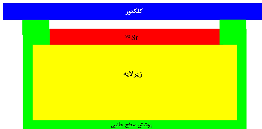
شکل ۴-۱. چشمه با زیرلایه و پوشش سطح جانبی در مقابل کلکتور صفحه‌ای
