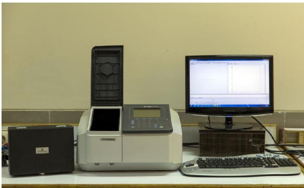
شکل ۲-۴: دستگاه طیف سنجی اپتیکی مورد استفاده در دانشکده فیزیک دانشگاه صنعتی شاهرود.
