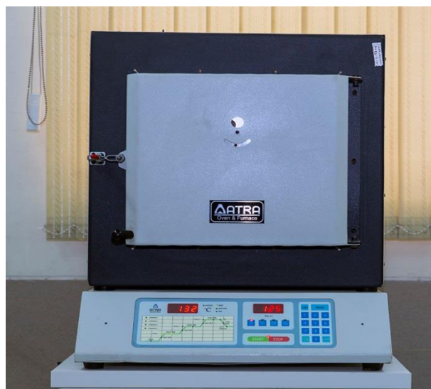
شکل ۳-۴: تصویر کوره جعبه ای موجود در دانشگاه صنعتی شاهرود که جهت خشک سازی لایه ها مورد استفاده قرار گرفته است.
