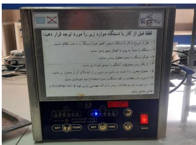
شکل ۳-۲: تصویر دستگاه فراصوتی در دانشگاه صنعتی شاهرود که برای شستشوی زیرلایه ها استفاده شد.
