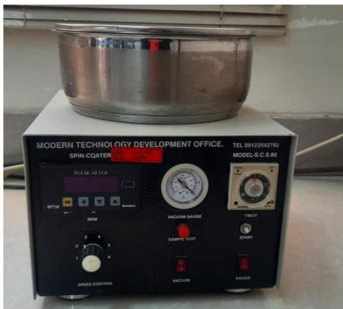
شکل ۱-۳: تصویر دستگاه لایه نشانی چرخشی در دانشگاه صنعتی شاهرود که برای لایه نشانی استفاده شد.
