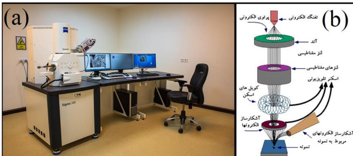
شکل ۱-۲ (a) تصویری از میکروسکوپ الکترونی روبشی اثر میدانی (مدل Sigma 300- HV) بکار گرفته شده در دانشگاه صنعتی شاهرود، (b) طرح شماتیکی از اجزای داخلی مسیر عبور باریکه تا سطح نمونه.
